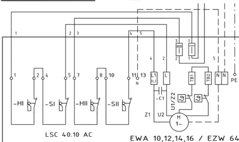
Abb. 3: Antrieb, Endlagenschalter und Schaltplan-Darstellung des Endlagenschalters
