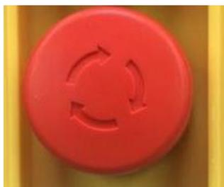
Abb. 1: Not-Aus-Taster im Hängetaster
