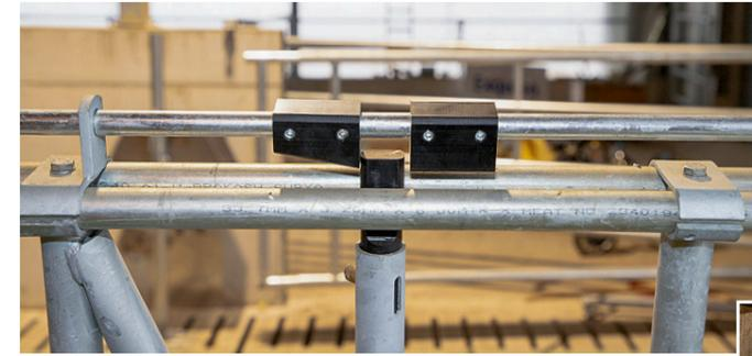
In diesem Fall ist der über ein Rohr verbundene Schließmechanismus so gedreht, dass die Tiere fixiert werden.
