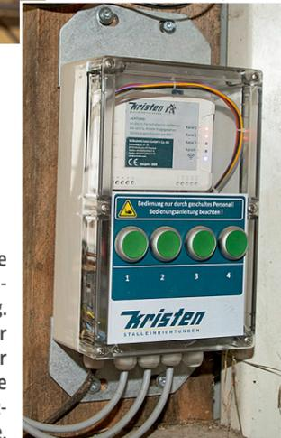
Signal ankommt. Die Steuerbox verfügt als nachrüstbare Insellösung zum Öffnen und Schließen von bis zu vier Gattern mit maximal 240 Tieren über vier Druckknöpfe – für jeden Abschnitt einen Knopf zum Ver- und Entriegeln. Die Insellösung hat dabei den Vorteil, dass der Besamungsdienst oder der Hoftierarzt das Fressgitter per Knopfdruck ohne Handy öffnen und schließen kann.
